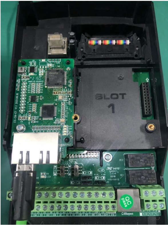
图 1-1 EtherCAT 卡安装方式
