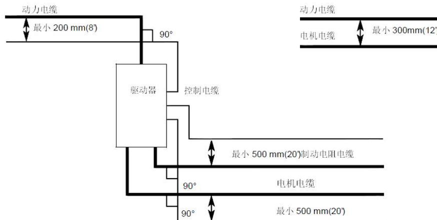
图 3.3 电缆布线图
