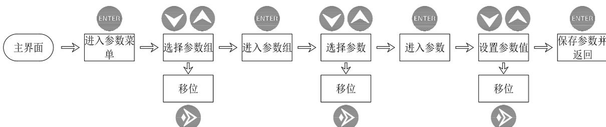
5) 使用外接可拆卸的 LCD 键盘控制时，本地控制模式为转速时设置 21.00 速度给定 1 信号源为 02.08（控制面板给定 1）；本地控制模式为转矩时设置 24.00 转矩给定 1 信号源为 02.09（控制面板给定 2）。切换为电位器给定时，本地控制模式为转速时设置 21.00 速度给定 1 信号源为除 02.08（控制面板给定 1）均可以；本地控制模式为转矩时设置 24.00 转矩给定 1 信号源为除 02.09（控制面板给定 2）均可以。
