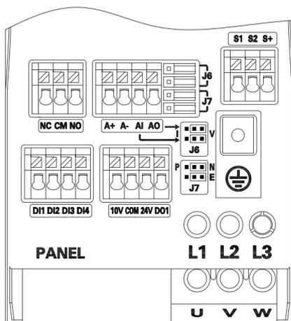
图 3.2 电气接线端子布局
