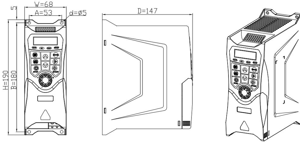
图 3.1 外形及壁挂式安装尺寸示意图
